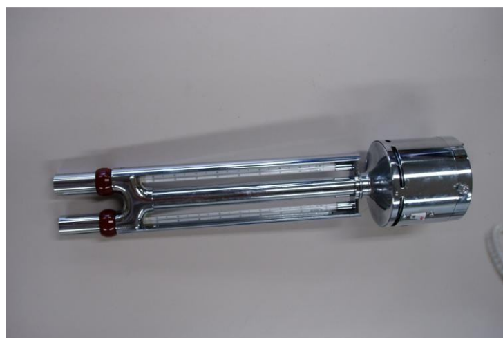
Рис. 16.1. Аспіраційний психрометр Асмана: а – конструкція психрометра; б – зовнішній вигляд
