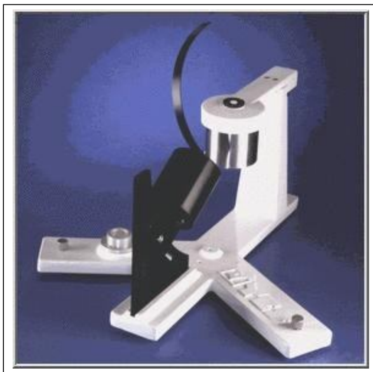
Рис. 6.4 . Радиометр, обладнаний кільцеподібною стрічкою, для вимірювання дифузного сонячного випромінювання
