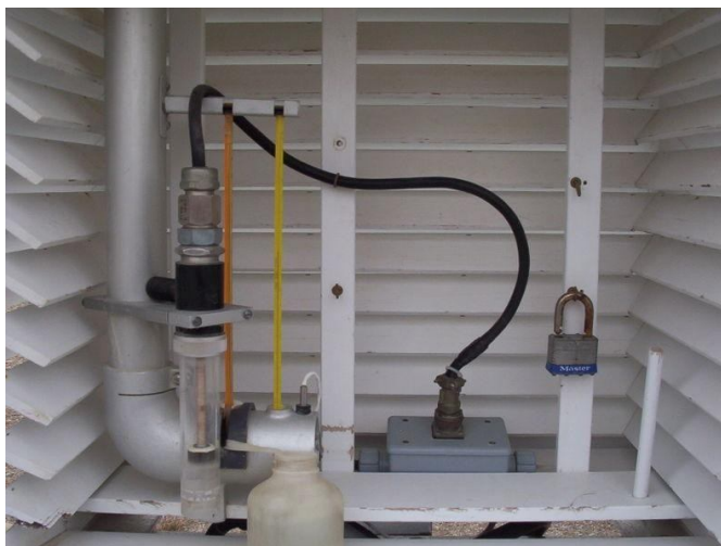
Рис. 16.2. Автоматизований аспіраційний психрометр Асмана
