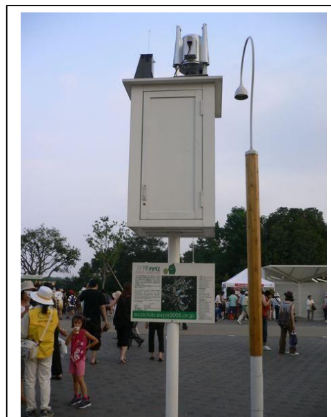
Рис. 4.6. Зовнішній вигляд системи наземних спостережень AMeDAS [22]
