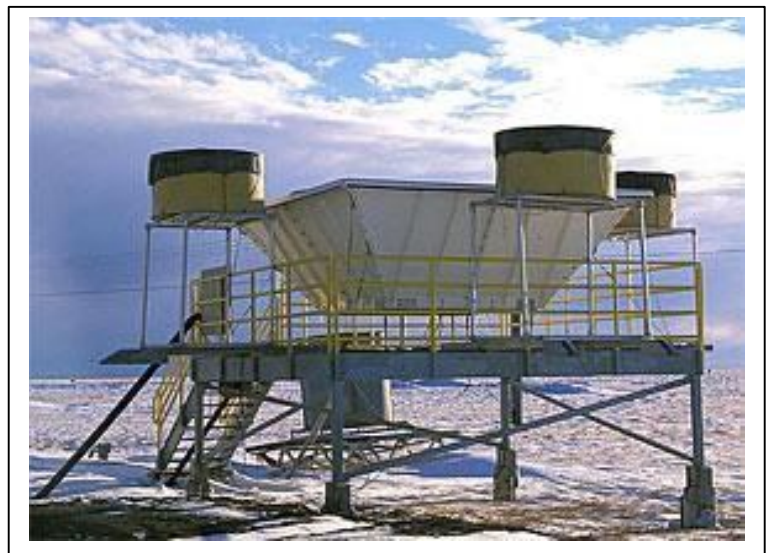
Рис. 4.2. Ультразвукова система Radio Acoustic Sounding System (RASS) (Фінляндія), що встановлена на узбережжі Аляски [20]
