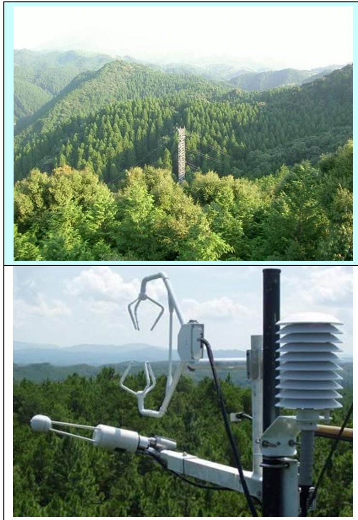
Рис. 20.1. Метеорологічна вежа Кахоку (Японія): а – загальний вигляд; б – комплект приладів для вимірювання вихрової коваріації
