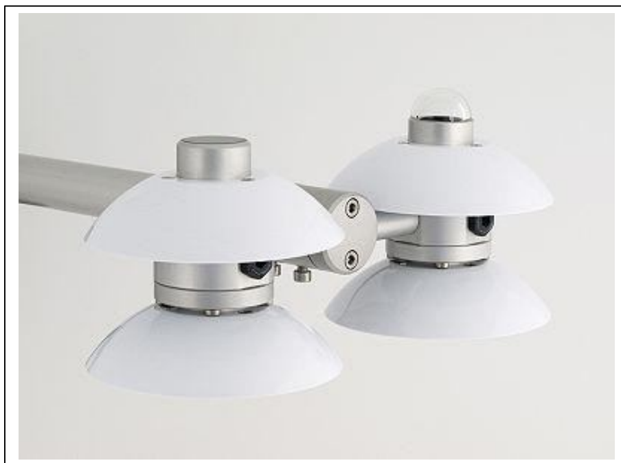
Рис. 6.11. Чотирикомпонентний радіометр, що складається з двох пар піранометрів (з сферичними вікнами) та піргеометрів (з плоскими вікнами)
